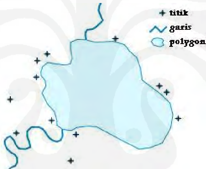
Gambar 2.2. Contoh peta vektor sederhana yang tersusun atas bentuk titik, garis, dan polygon [2]
