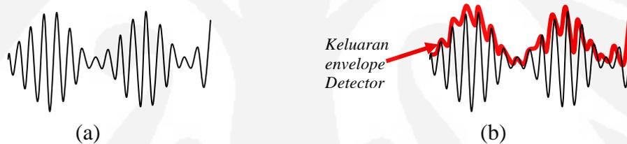
Gambar 3.5. Bentuk Sinyal I/O *envelope detector* (a) Masukan; (b) Keluaran
