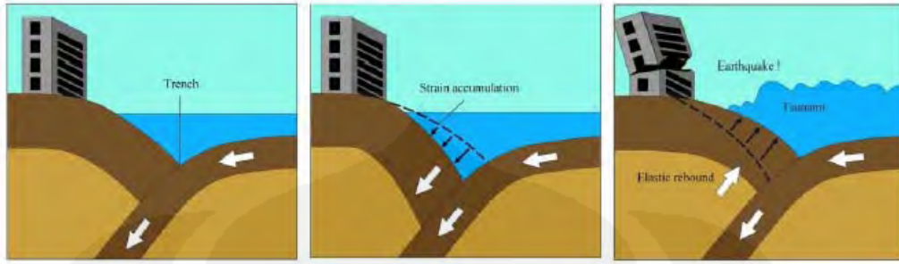
Gambar 2. 4 Pergerakan lempeng bumi pada daerah patahan yang akan menimbulkan deformasi dasar laut secara vertikal yang akan menyebabkan timbulnya gelombang tsunami [Mori 2004]. [5]
