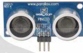
Gambar 2.1 Bentuk fisik PING [9]
