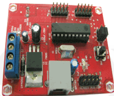
Gambar 2.4. Mikrokontroler AT TINY2313 yang Tersedia Dipasaran.[6]
