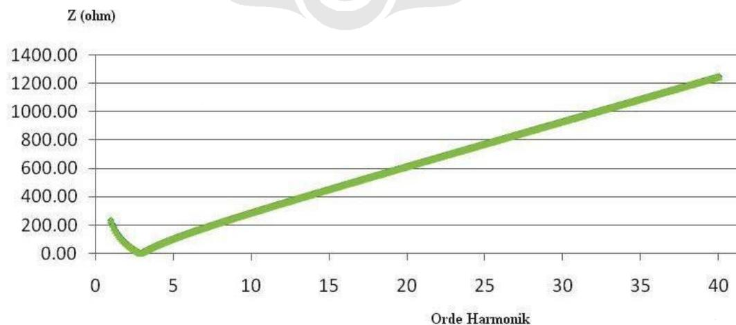
Gambar 4.28. Kurva Impedansi Single Tuned Filter
