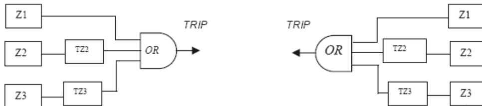
Gambar 2.15 Skema logika pengamanan dasar rele jarak
