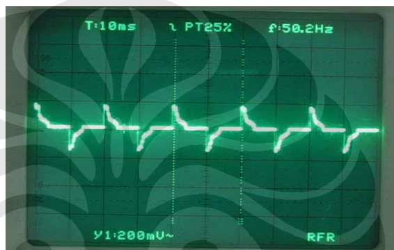
Gambar 4.1 Bentuk gelombang arus kondisi tunak lampu hemat energi 8 Watt pada osiloskop
