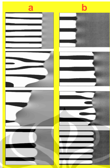
Gambar 2.13. Evolusi Struktur Mikro Lamelar Dengan Laju Pendinginan Yang a. Menurun b. Meningkat [6]
