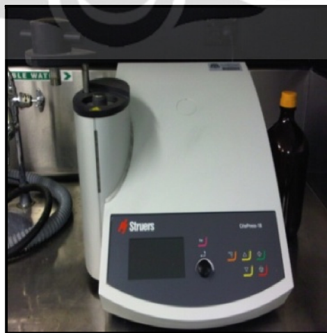
Gambar 3.15. Mesin mounting CitoPress-10 yang digunakan dalam preparasi sampel metalografi.
