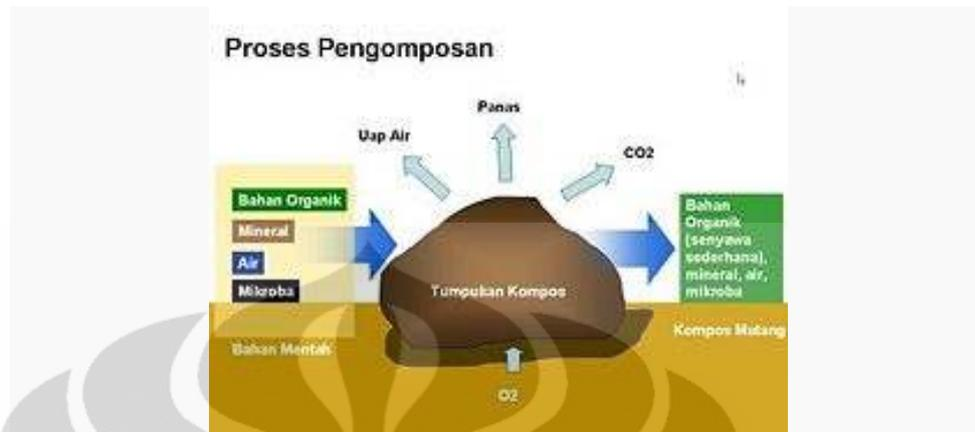
Gambar 2.8. Skema Proses Pengomposan Aerobik
