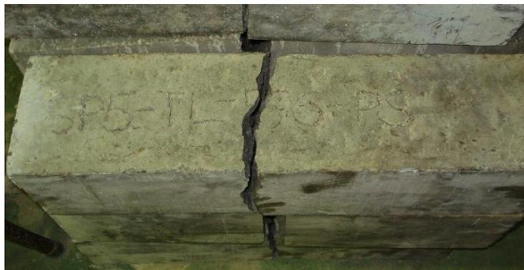
*Foto 9. Keruntuhan di Tengah Bentang pada Benda Uji Lentur*
