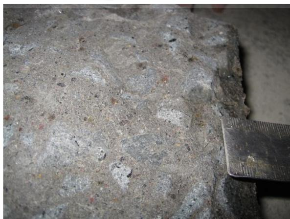
*Foto 12. Pengukuran Penetrasi Air pada Benda Uji Permeabilitas*
