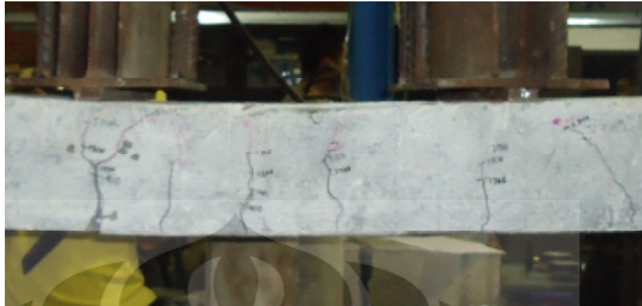
Gambar 4.31 Pola Retak Benda Uji HCS SF 0,32%-3 Sisi 1
