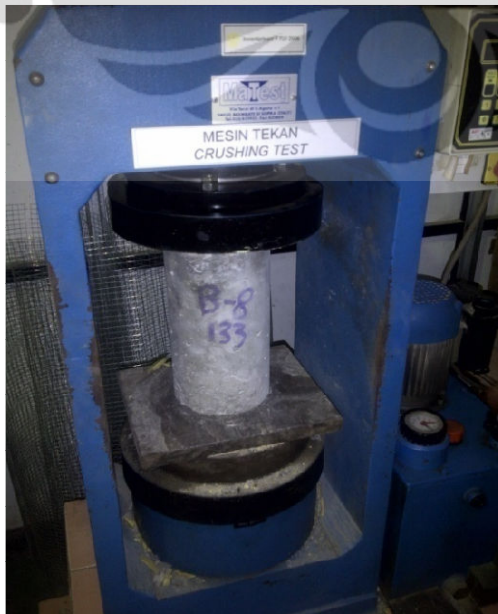
Gambar 4.2 – Uji Tekan Beton
