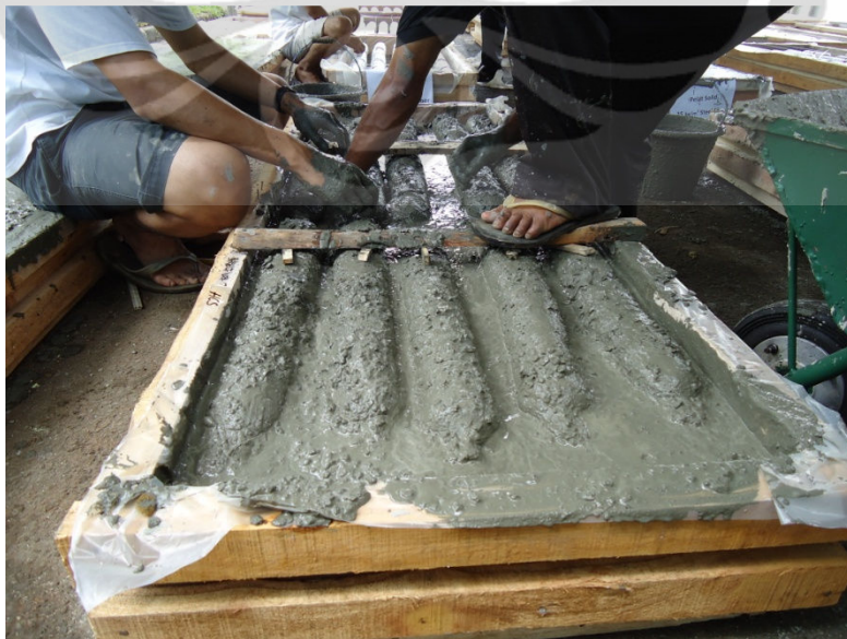
Gambar 4.53 – Botol Naik ke Permukaan pada HCS tanpa Sengkang
