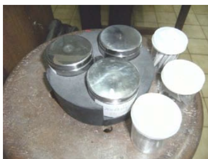
Gambar 3. 1: Vial dari VBM dan bahan dasar siap dimilling
