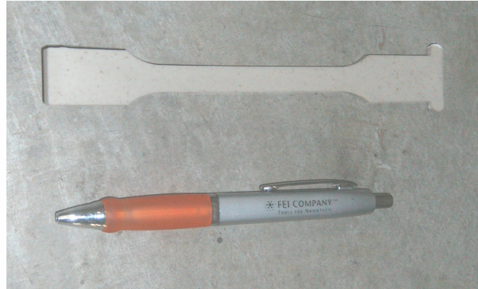
Gambar 4.6. Spesimen dog bone yang dicetak dengan mesin injeksi molding
