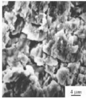
Gambar 2.6. Fraktur Intergranular pada Sn – 0 ,7 Cu (Yanfu, Lifang, Keke & Jiuba, 2007)
