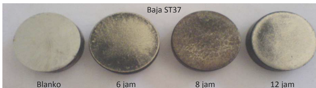
Gambar 4.14 Hasil abrasif lapisan borid pada baja ST37 berdasarkan waktu boronisasi.
