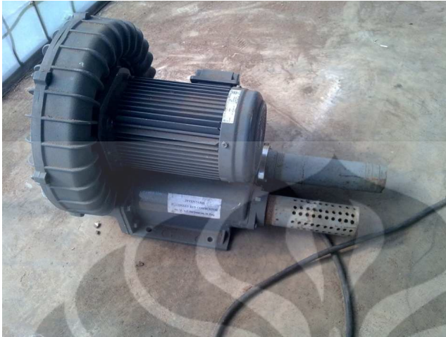
Gambar 2.17 Blower Ring yang Digunakan pada FBC
