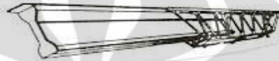
Gambar 2.6. Pemikul yang dapat digeser dengan pemikul-pemikul dalam (dinding penuh) dan pemikul luar (kerja rangka)
