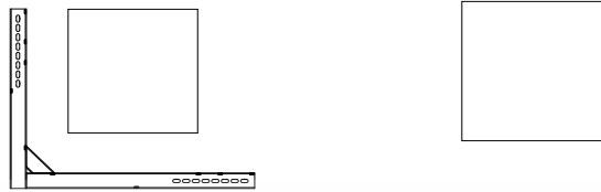
Gambar 2.21. Tampak atas bekisting kolom system PERI (PT. Beton Konstruksi Wijaksana)
