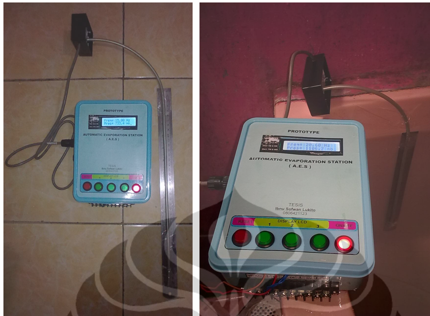
Gambar 4.1. Proses pengukuran ketinggian air dengan pressure sensor BP11.
