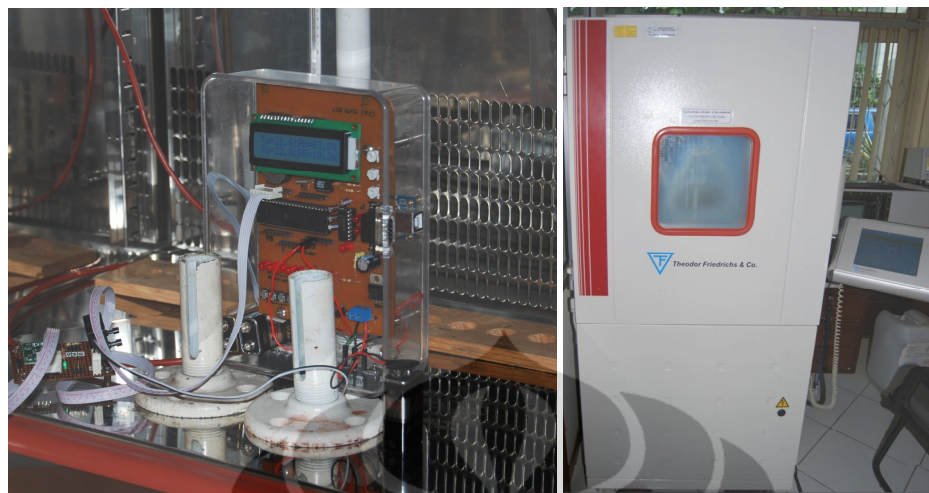
Gambar 4.4. Pengujian akuisisi data sensor DS18B20 dan SHT11 di Lab.PUSINREKAL
