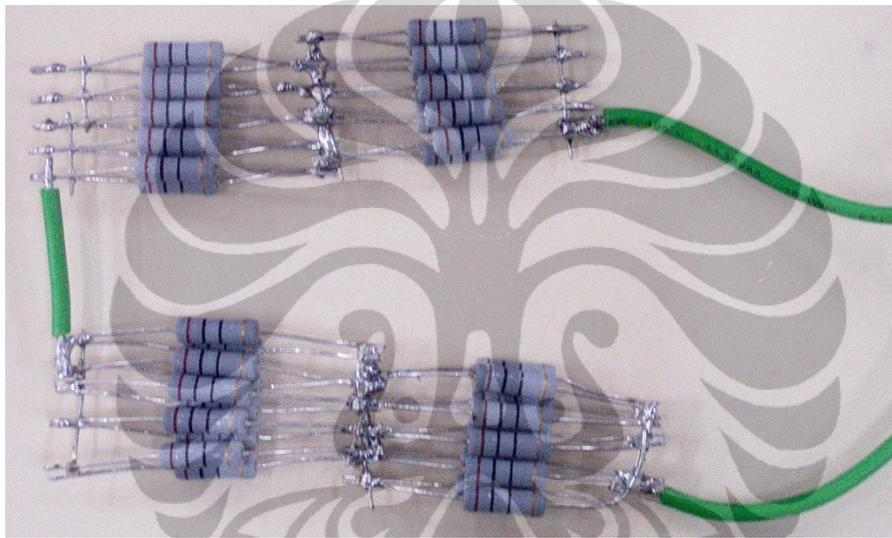
Gambar 4.1: Resistor beban untuk ujicoba *ultrasonic generator*
