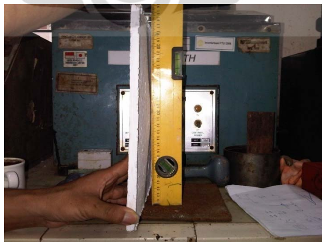
Gambar 4.22. Deformasi yang terjadi akibat beban terpusat pada benda uji 1
