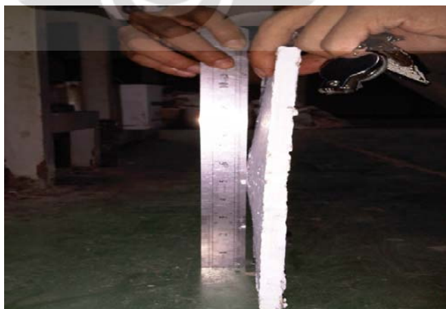
Gambar 4.29. Deformasi yang terjadi akibat beban terpusat pada benda uji 2
