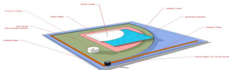
Gambar 3.3 Diagram alat untuk membuat spesimen dengan menggunakan metode VARI
