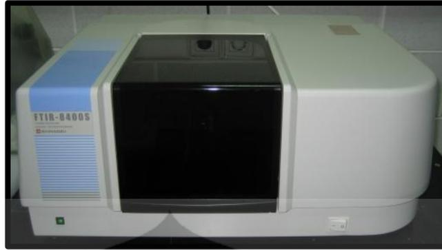
Gambar 4.15 Alat spektrofotometer inframerah SHIMADZU FTIR-8400S
