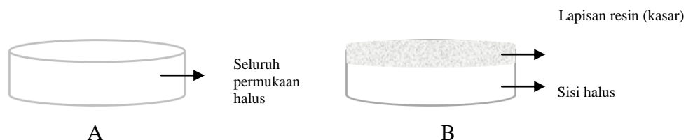
Gambar 4.4. Ilustrasi potongan gel (A) Diffusive gel (B) Resin Gel
