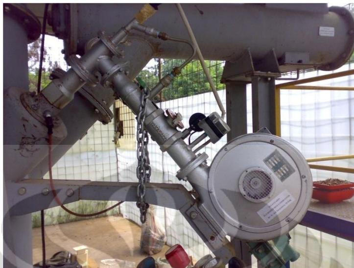
Gambar 2.16 *Burner* yang digunakan pada *Fluidized Bed Combustor* UI
