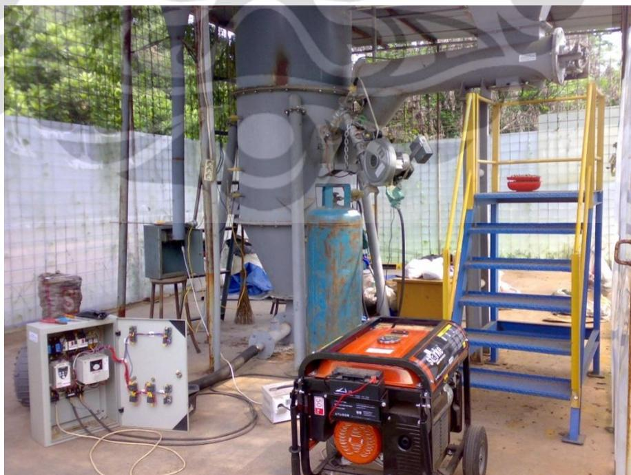
Gambar 3.12 Rangkaian seluruh alat untuk melakukan pengujian pembakaran
