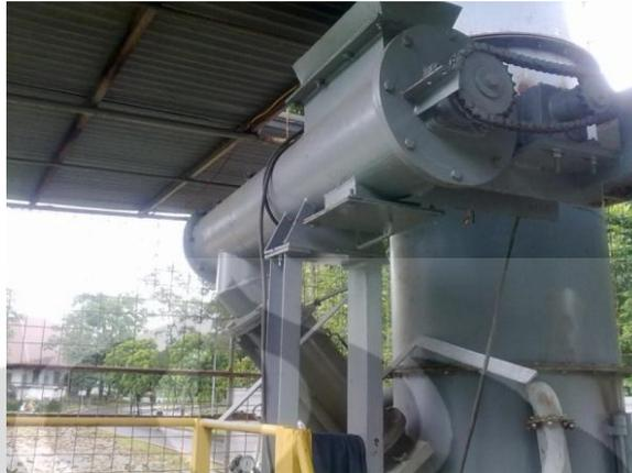
Gambar 3.9 Sistem feeder pada *fluidized bed combustor* UI
