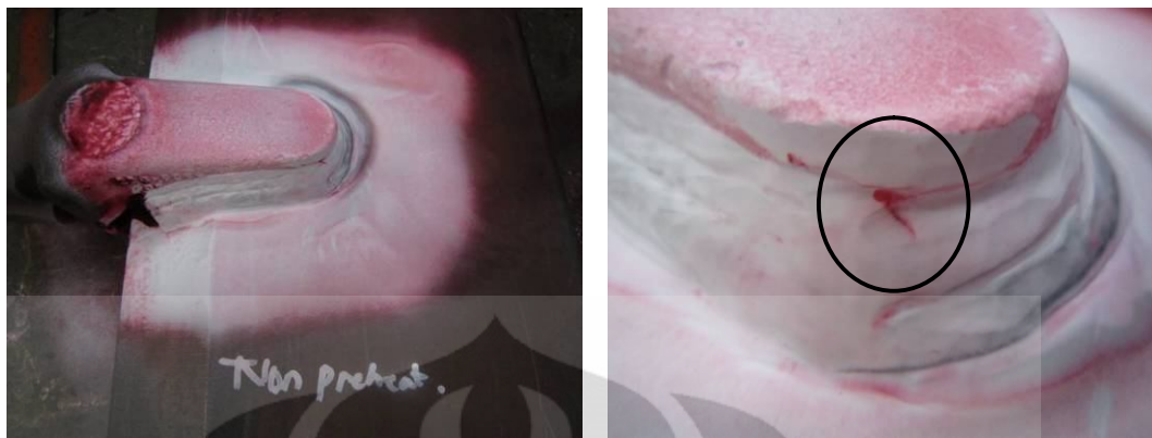
Gambar 4.1. Inspeksi las pada sampel tanpa preheating dengan uji penetrant
