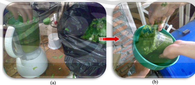
Gambar 3.11 (a) Eceng gondok diblender, (b) Slurry eceng gondok dialirkan ke dalam digester.
