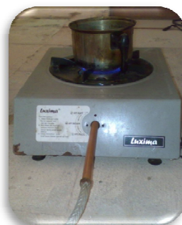
Gambar 4.12 Penggunaan biogas untuk memasak
