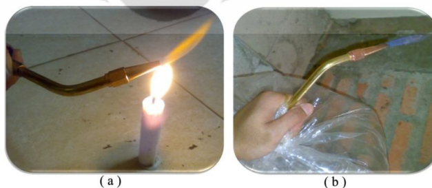
Gambar 4.9 Uji nyala api dengan nosel las. (a) Penyalaan dibantu dengan lilin. (b) Penyalaan tanpa dengan bantuan lilin
