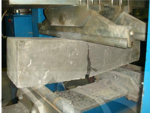
**Gambar 4.8** Uji Kuat Lentur dengan Pembebanan Sepertiga Bentang pada Balok Sederhana
