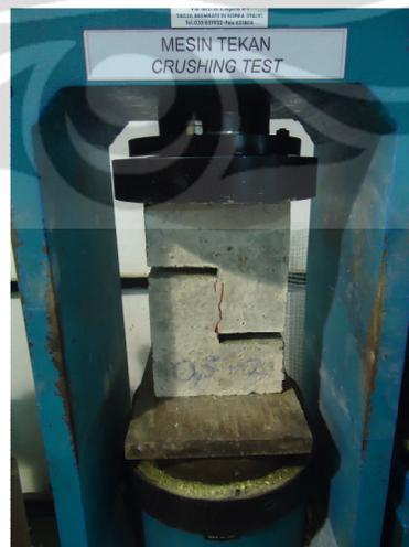
**Gambar 4.14** Uji Kuat Geser dengan Pola Retak yang Ideal
