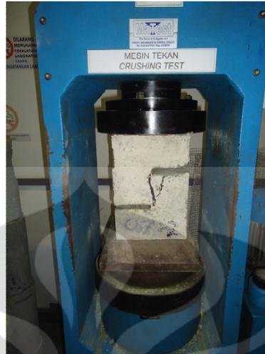
**Gambar 4.15** Uji Kuat Geser dengan Pola Retak yang Tidak Ideal
