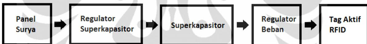
Gambar 3.1 Panel Surya Dengan Superkapasitor Sebagai Penyimpan Energi
