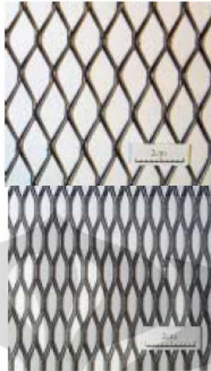
Gambar 2.5 Material Yang Digunakan Dalam *Ferrocement*
