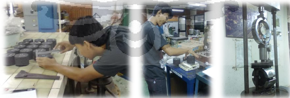
Pengukuran Volumetrik dan Pengujian Marshall
