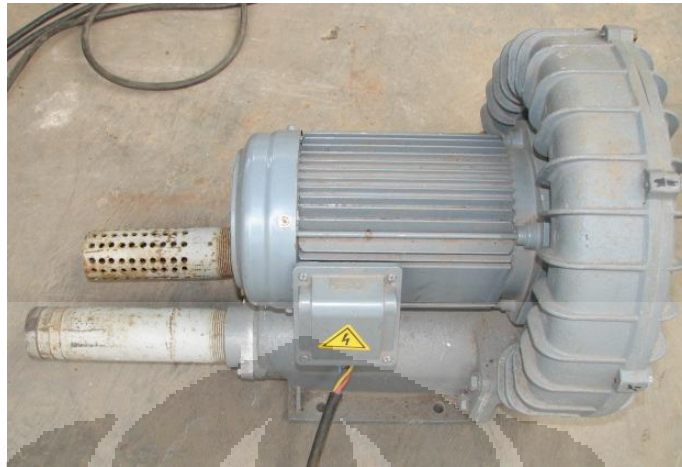
Gambar 3.19 Ring Blower pada Fluidized Bed Combustor UI
