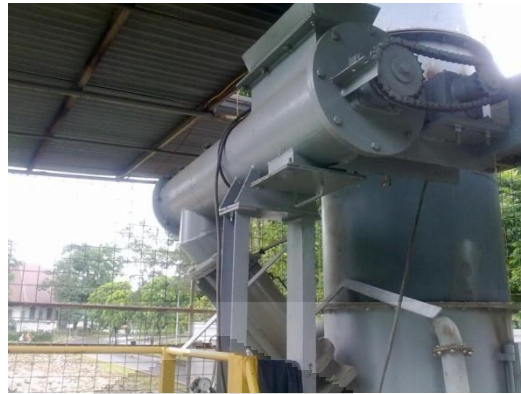
Gambar 3.34 Sistem feeder pada fluidized bed combustor UI
