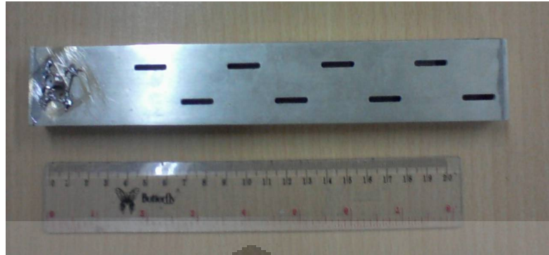
Gambar 4.1 Hasil Fabrikasi Antena Waveguide 8 Slot
