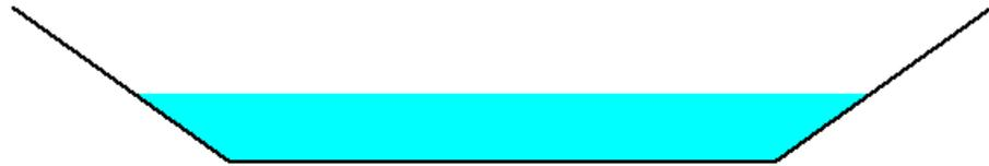
Gambar 5.4. Ilustrasi Kedalaman Air Rata-Rata di Saluran Outlet DTA tahun 2010 (0,88-m) saat terjadi Aliran Puncak akibat Hujan Kala Ulang 2-tahunan (131-mm/24-jam)
