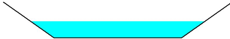
Gambar 5.8. Ilustrasi Kedalaman Air Rata-Rata Saluran Outlet DTA tahun 2025 setelah dipasang LID BMP (0,91-m) saat terjadi Aliran Puncak akibat Hujan Kala Ulang 2-tahunan (131-mm/24-jam)
