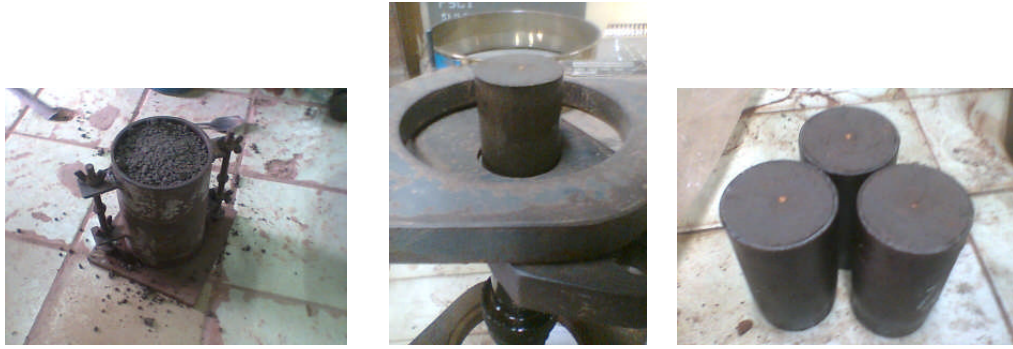
Gambar : Pembuatan contoh Uji Triaksial CU
