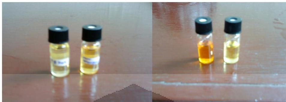
Hasil oksidasi dengan katalis  $\gamma\text{-Al}_2\text{O}_3\text{-TiO}_2$  &  $\text{Al}_2\text{O}_3\text{-TiO}_2$  (1:1) PEG dengan oksidator ozon
