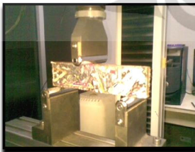
Pengujian Lentur Kering Sisi Lebar Menerima Beban
