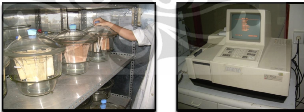
Gambar 4.6. Conditioning pada 20 \pm 0.5 °C, selama 24 jam dan alat spectrophotometer
