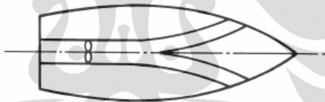
Gambar 1.2 Prinsip konsep asli Kort nozzle
