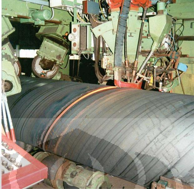
Gambar 2.4 Proses Pabrikasi Pipa Pengelasan Spiral
