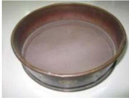
Gambar 3.2. Saringan Pasir No. 18 yang Digunakan untuk Mengayak Media
