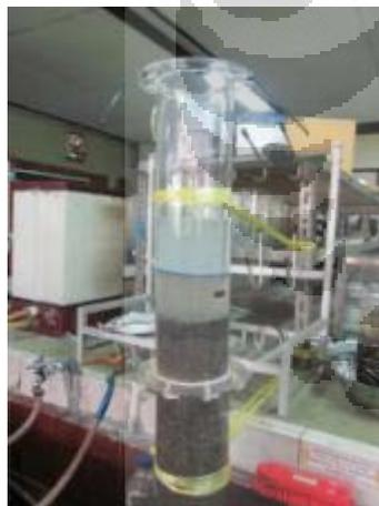
***Biosand Filter* Skala Laboratorium**
