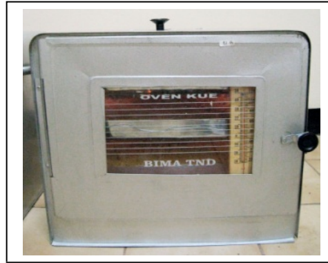
Gambar 3.1. Inkubator sederhana yang digunakan untuk pengeringan formula.
