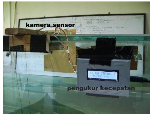
Gambar 3.16 Pemasangan seonsor alat pengukur kecepatan
