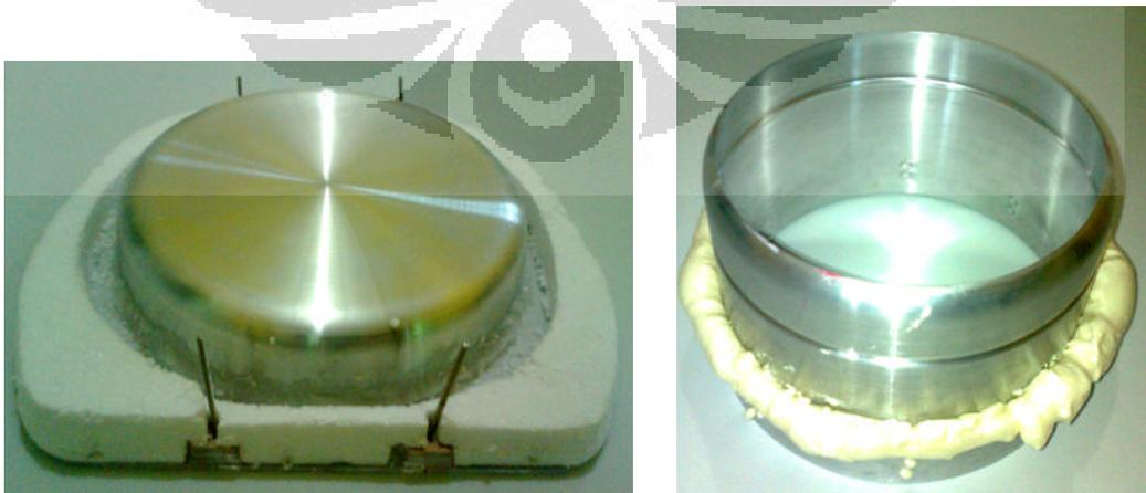
**Gambar 3.13** Isolator sterofoam dan polyurethane
