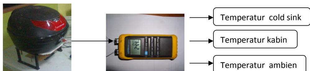
**Gambar 4.12** Skema pengujian cool box di jalan raya
