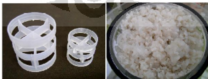
Gambar 2.7 Pall Rings komersial (kiri) dan biofilter dengan isian Pall Rings yang mengandung sel terimobilisasi (kanan)
