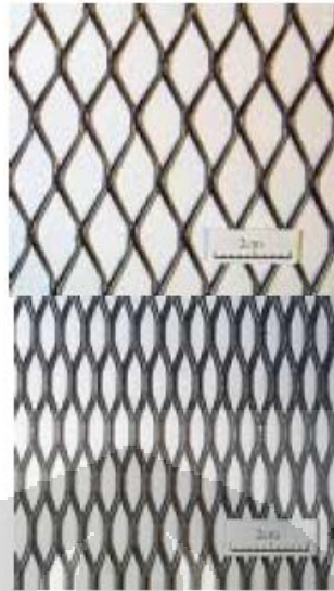
Gambar 2. 5. Material yang Digunakan dalam Ferrocement (Sumber: Abrams, D. P., Lynch, J. M., 2001)
