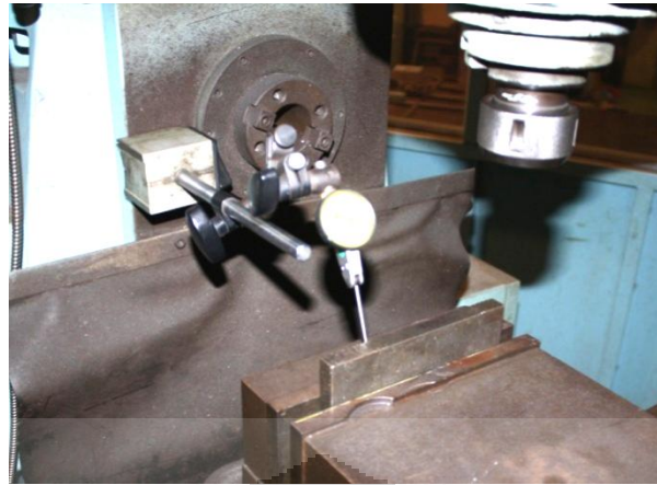
Gambar 3.27. Penyetingan ragum dengan dial Indikator
