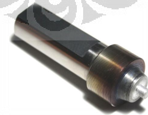
Gambar 3.18. Tool FSW dengan Cyl probe \varnothing 5 mm
