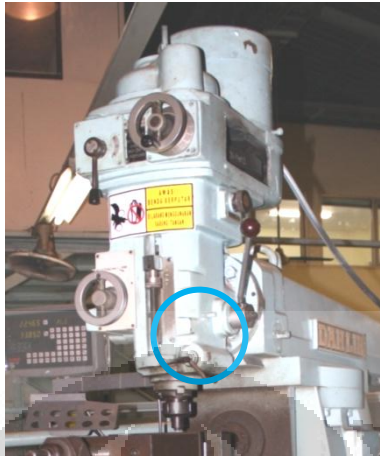
Gambar 3.37. Posisi kunci spindle sumbu Z
