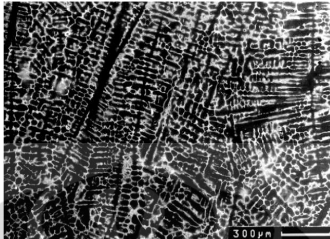
Gambar 2.3. Mikrostruktur butir kolumnar/dendritik material IN -519 (50X) [6] .
