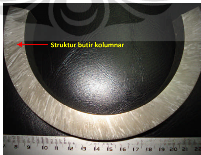
Gambar 4.2. Potongan penampang melintang tube dengan struktur butir kolumnar, elektrodsa dengan asam oksalat 15%.
