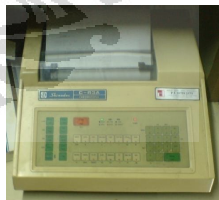
Lampiran A.4. GC FID dan recorder yang digunakan untuk analisis formaldehida
